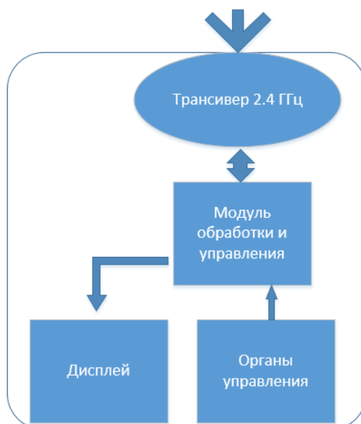
Рисунок 11 – функциональный состав пульта управления
