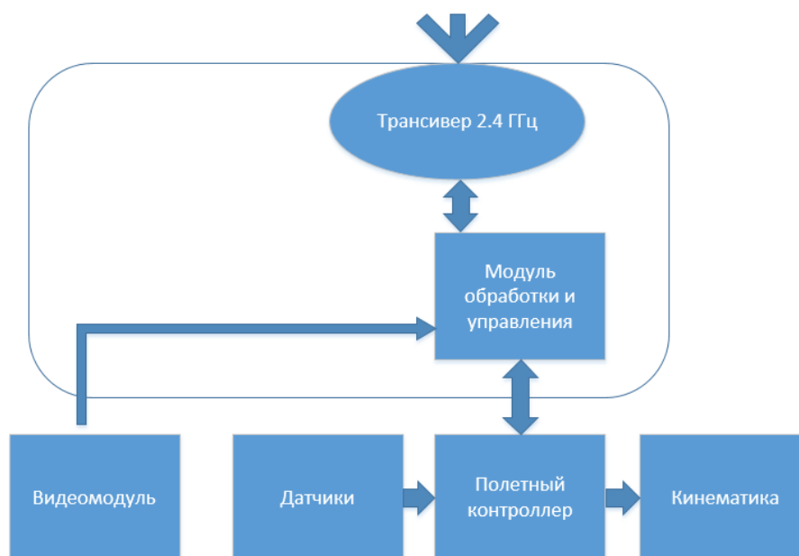
Рисунок 12 – функциональный состав радиомодуля БПЛА
