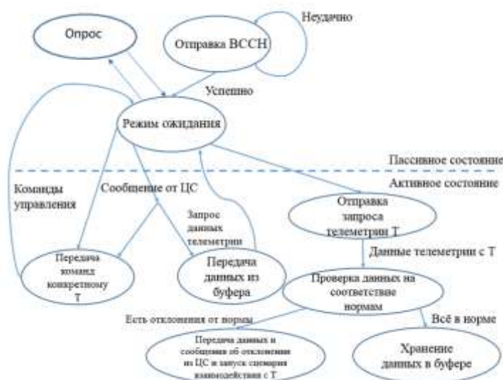
Рис. 10 Диаграмма состояний точки доступа.
