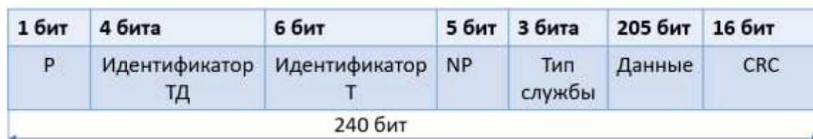
Рис. 14 Структура сообщений канала DCH.
