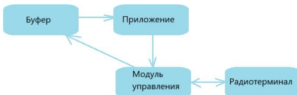
Рис.7 Функциональный состав ПУ
