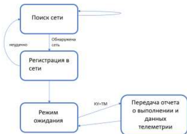
Рис. 11 Диаграмма состояний терминала
