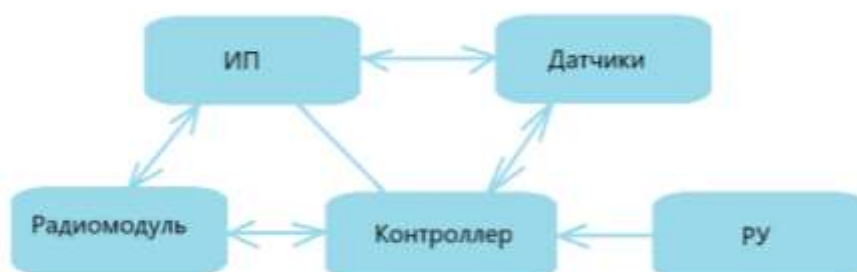
Рис. 8 Функциональный состав терминала
